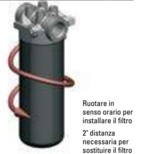
Ruotare in senso orario per installare il filtro
