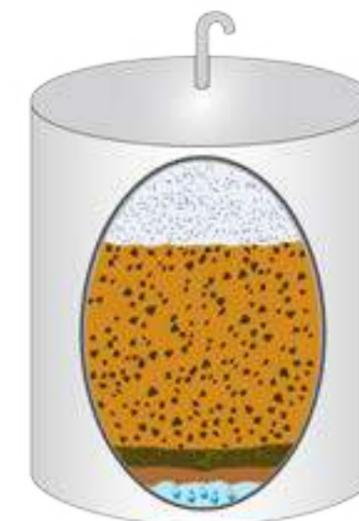
Tipico serbatoio di combustibile contaminato da sporco, acqua e crescita microbica
