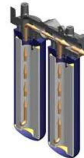
I fluidi passano attraverso il supporto filtrante e i target di pulizia sono raggiunti con un metodo single-pass.
