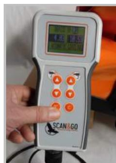
Premendo semplicemente il pulsante **0°**, il sistema procede automaticamente, tramite gli attuatori elettrici, al movimento del piano fino ad ottenere l'orizzontalità del piano stesso su entrambi gli assi.
