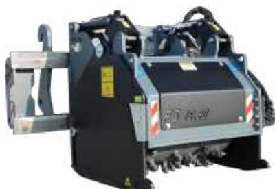
Con lo scopo di smantellare le croste del manto stradale, del cemento nei piazzali, di grattare la roccia o semplicemente di creare attraversamenti o tracce dove sia pavimentato, è prodotta in 8 modelli con larghezza da 25 a 100 cm ed è applicabile a mini pale, terne e pale gommate idrostatiche.
