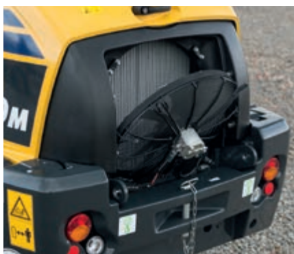
La ventola radiatore inclinabile facilita l'accesso per la pulizia
