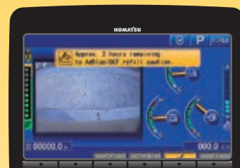
Guida rifornimento e livello AdBlue®
