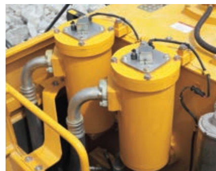
Indicatore d'intasamento del filtro nella linea di ritorno protegge il impianto idraulico
