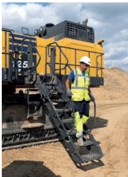
La scala azionata idraulicamente offre una maggiore sicurezza di entrata e di uscita dalla macchina.
