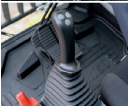
Comandi comodi, ergonomici e precisi: manipolatori (leve corte disponibile come optional)
