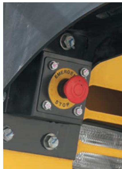
Tre interruttori d'emergenza per l'arresto del motore sono installati di serie in cabina e attorno alla macchina.
