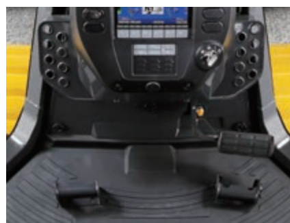
Pedale combinato deceleratore-freno
