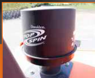
Prefiltro centrifugo Donaldson® Top Spin™
