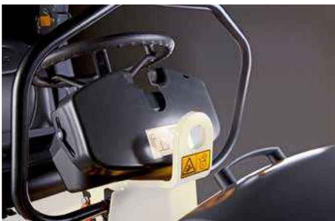
Un robusto punto di sollevamento centrale rende facili e veloci le operazioni di carico e scarico.
