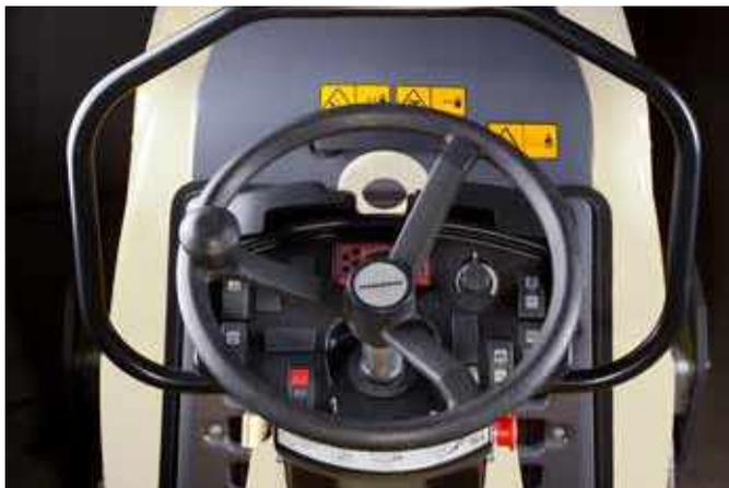
Il pannello comandi è di facile lettura e include l'indicatore di livello del carburante. La postazione dell'operatore è isolata dalle vibrazioni.
