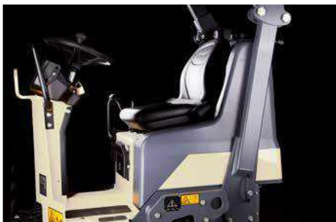
La spaziosa piattaforma isolata dalle vibrazioni, il sedile comfort e la doppia leva di avanzamento/retromarcia garantiscono il comfort totale per l'operatore.
