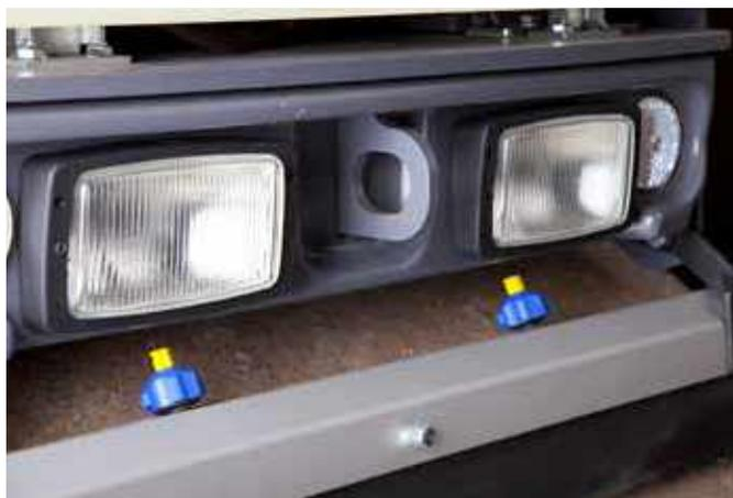
Sistema di spruzzatura pressurizzato dotato di potente pompa e tubi ed ugelli autopulenti.
