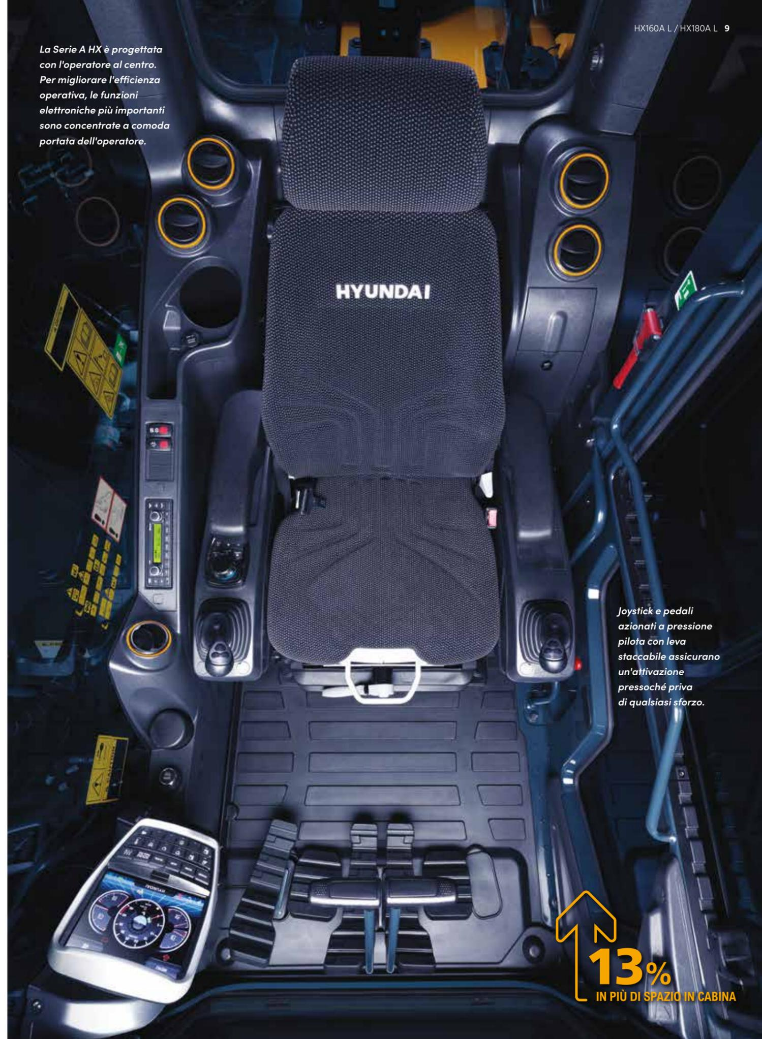
Joystick e pedali azionati a pressione pilota con leva staccabile assicurano un'attivazione pressoché priva di qualsiasi sforzo.
