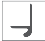
APPOGGIO A GOCCIA BOTTOM HOOK CONNECTION
