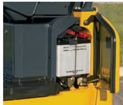
Cofano sinistro: accesso alla batteria
