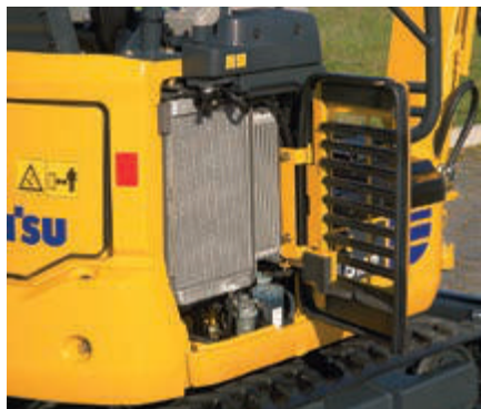
Cofano destro: ispezione e pulizia dei radiatori
