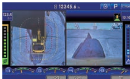
Con KomVision, varie opzioni di configurazione delle viste offerte dalle telecamere aiutano ad avere una visibilità totale costante dall'alto della macchina
