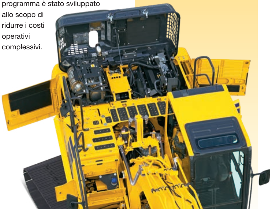
Guida rifornimento e livello AdBlue®
