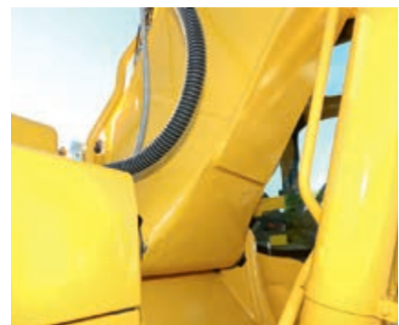
Lamiere monopezzo e terminali in fusione per la base del braccio
