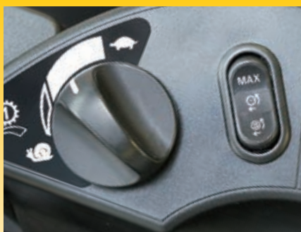
Quadrante di controllo con sistema di cambio velocità di traslazione a strisciamento (sinistra) e pulsante del sistema di controllo variabile della trazione (destra)
