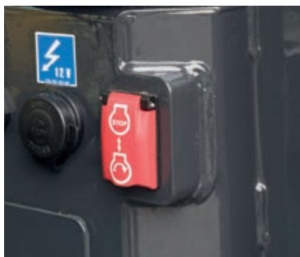
Interruttore secondario di spegnimento motore
