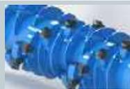
Di serie su FFL riduttore di profondità di taglio che permette al rotore di mantenere un numero costante di giri e di preservare la vita dell'utensile.
