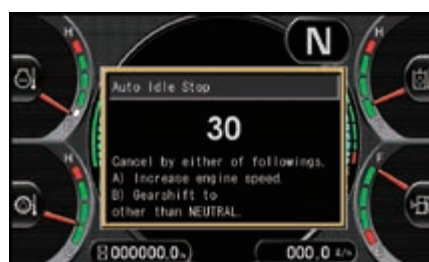
Spegnimento regolabile in caso di inattività arresta il motore dopo che è rimasto in folle per un intervallo di tempo prestabilito
