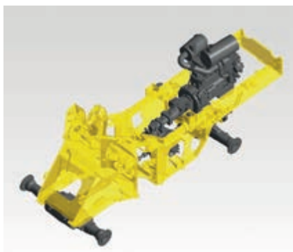
Solido telaio resistente alle sollecitazioni torsionali
