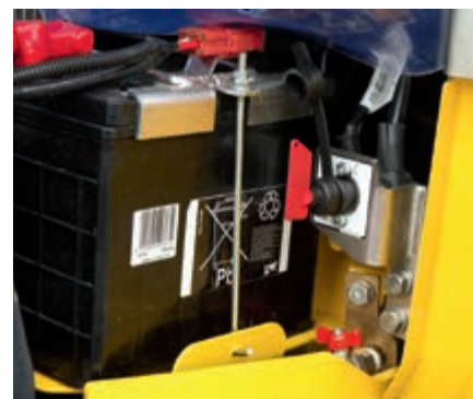
Interruttore di sicurezza dell'impianto elettrico di serie
