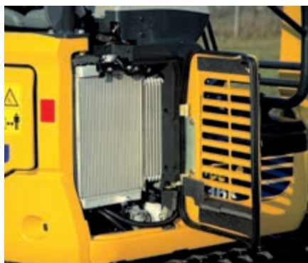
Cofano destro: ispezione e pulizia dei radiatori
