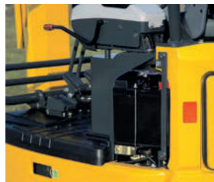
Cofano sinistro: accesso alla batteria
