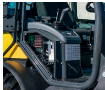
Cofano laterale per rapide operazioni di manutenzione
