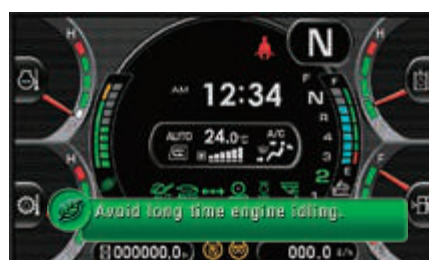
L'indicatore Eco e la guida Eco con raccomandazioni attive che contribuiscono a massimizzare il risparmio di carburante
