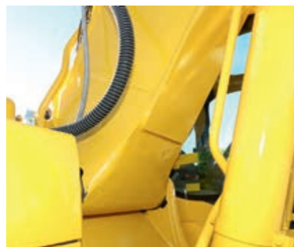
Lamiere monopezzo e terminali in fusione per la base del braccio
