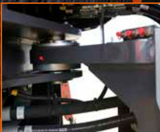
I collegamenti sono ben sistemati e facilmente accessibili nella cerniera di articolazione
