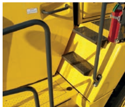
Sicuro accesso alla cabina con corrimano, lontano dal punto di articolazione che può essere potenzialmente pericoloso
