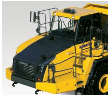
Sistema ROPS/FOPS integrato conforme alle norme ISO 3471 e SAE J1040-1988c
