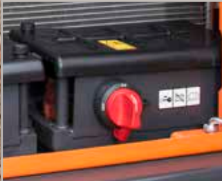
Sezionatore della batteria
