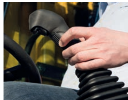
Per sterzate frequenti, il sistema opzionale "Joystick di sterzo" permette di controllare la macchina con meno sforzo
