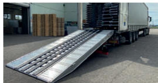
Piattaforma di carico idraulica regolabile in altezza realizzata in lega di alluminio e telaio di supporto e movimentazione in acciaio utilizzata per il carico e lo scarico di veicoli con ruote e cingoli in gomma, rulli compattatori, veicoli a tre ruote, piattaforme aeree, veicoli cingolati in acciaio grazie ad una speciale superficie rinforzata. La parte centrale della rampa è rivestita in gomma per agevolare il carico e lo scarico dei rulli compattatori
