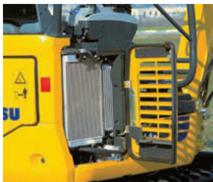
Cofano destro: ispezione e pulizia dei radiatori
