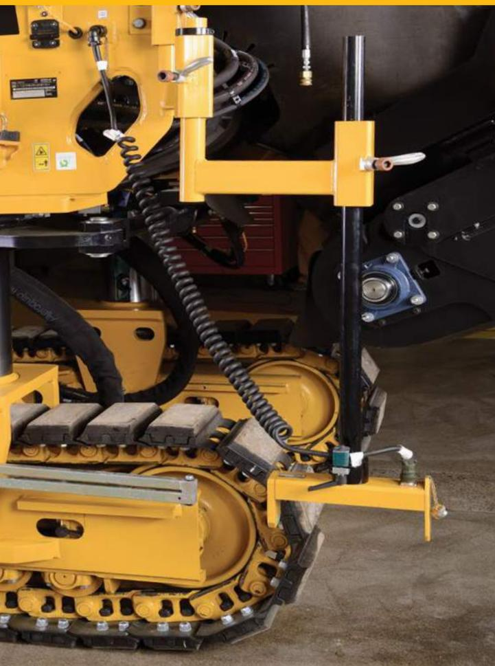
*Ogni sensore è dotato di cinque trasduttori; le letture massime e minime vengono scartate, le restanti tre letture vengono utilizzate per il calcolo della media effettiva.*
