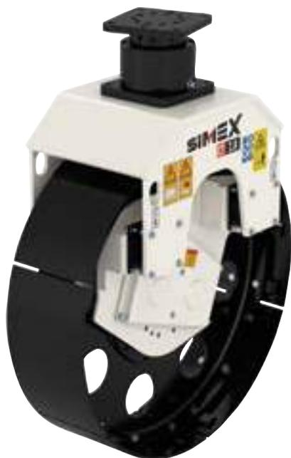
Progettati per **compattare il fondo degli scavi in sezione**, i compattatori vibranti a ruota Simex CT, garantiscono **un fondo solido, omogeneo e ben compattato**, che non cede nel tempo e consente la massima sicurezza nella circolazione stradale. **Perfetto isolamento** dalla macchina motrice, **grazie al doppio albero vibrante e controrotante**, posto al centro della ruota, si sommano le forze verticali e si annullano quelle orizzontali per un **maggior confort dell'operatore**.
