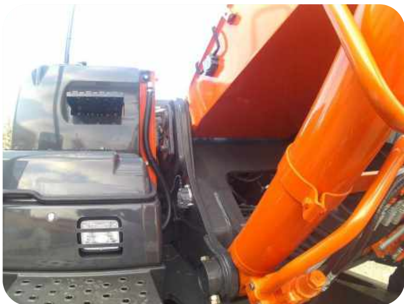
Sensore di Planarità + ROCKER (inclinometro) sul braccio BOOM
