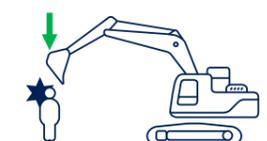
L'escavatore non è controllato dalla leva RCV e non è possibile l'azionamento involontario
