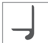
APPOGGIO A GOCCIA BOTTOM HOOK CONNECTION
