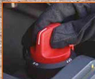
Sezionatore della batteria
