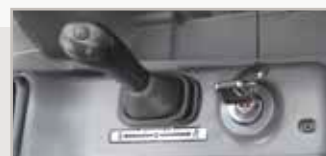
Interruttore per modalità di traslazione e funzione di flottazione della lama
