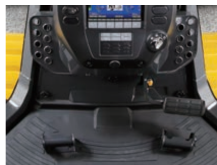
Pedale combinato deceleratore-freno
