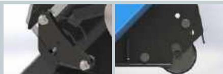
Rullo di appoggio posteriore regolabile su tre posizioni per la regolazione dell'altezza di taglio.
