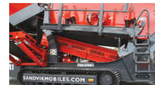
La struttura di sollevamento del vaglio consente un accesso facile
