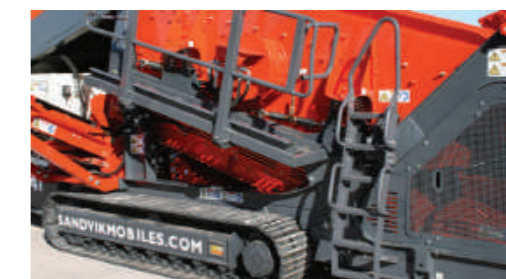
Scale per l'accesso alla cassa vibrante facile
