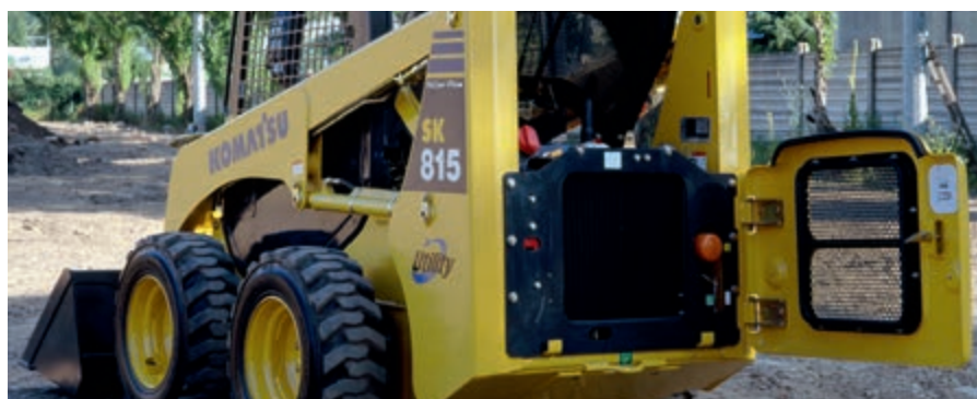
Il portellone: semplice ispezione e pulizia dei radiatori
