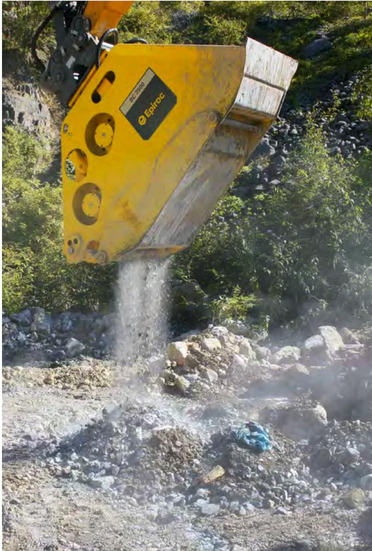
Le nostre Benne Frantumatrici coniugano la manutenzione ridotta con le elevate prestazioni. Inoltre la frantumazione in loco è sinonimo di minori costi di trasporto e di conferimento in discarica.
