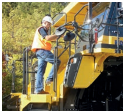
Accesso sicuro alla cabina grazie all'inclinazione ridotta della scala anteriore con corrimano, antiscivolo
