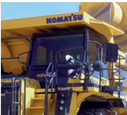
ROPS/FOPS secondo ISO 3471 ROPS e ISO 3449 FOPS livello II
