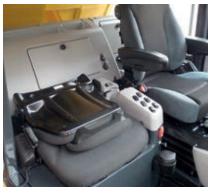
Il sedile passeggero a misura intera è pieghevole e ha una cintura di sicurezza con due punti di attacco retrattile.
