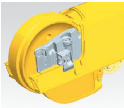
Supporto ruota folle a regolazione automatica
