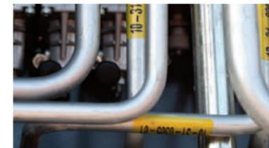
Tubazioni in acciaio per una migliore dissipazione del calore
