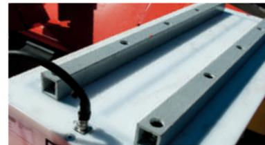
Rilevatore di metallo dotato di collegamento a ponte per il controllo del materiale in ingresso
