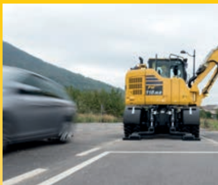
Ridotto raggio di rotazione posteriore
