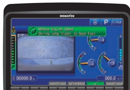
Indicatore Eco, guida Eco e indicatore livello carburante
