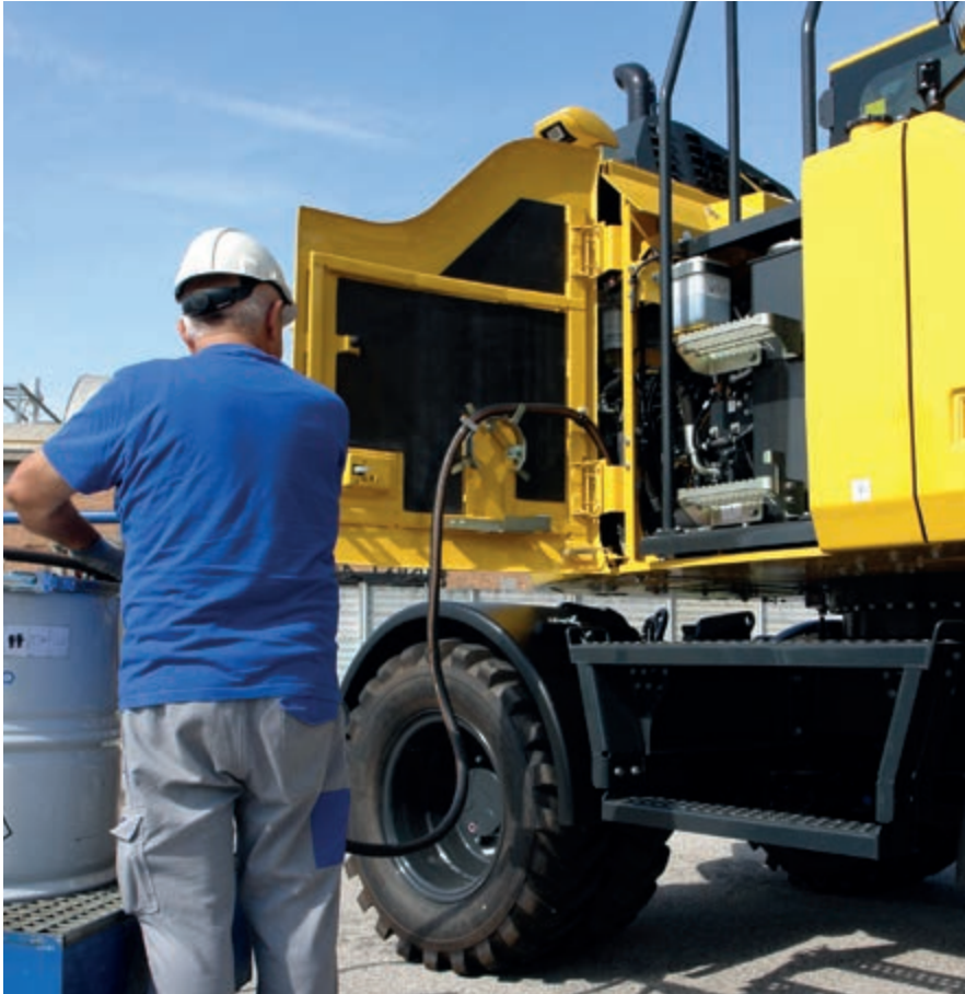
I più importanti punti di manutenzione possono facilmente essere raggiunti da terra
