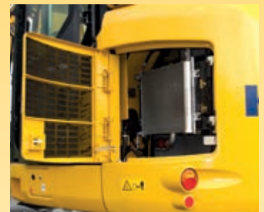
Le reti dello scambiatore sono integrate nel cofano motore ad apertura laterale per agevolarne la pulizia da terra
