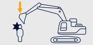
L'escavatore non è controllato solo dalla leva RCV e l'azionamento involontario è impedito
