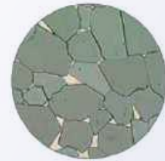
immagine ingrandita del carburo di tungsteno di inserti per condizioni di scavo morbide e abrasive
