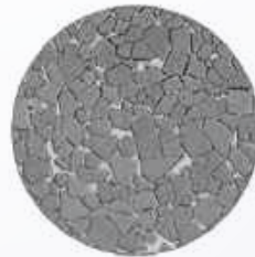
immagine ingrandita del carburo di tungsteno di inserti per condizioni di scavo dure e complesse
