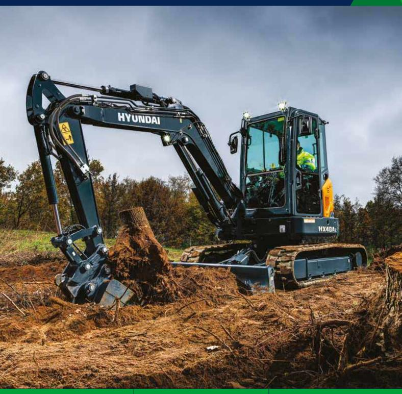
Potenza motore 24,8 CV (18,5 kW) – 39,0 CV (29,1 kW) Capacità benna 0,11 – 0,15 m³ Peso operativo 3.880 - 5.030 kg
