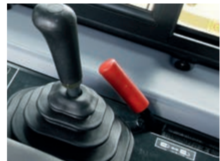
Leva di comando lama con pitch automatico e nuova leva di comando ripper con funzione auto-return
