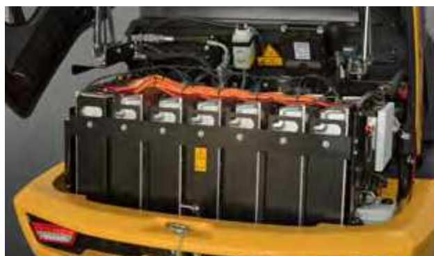
Scelta tra pacco batterie da 33 kWh o 40 kWh (L20 Electric)
